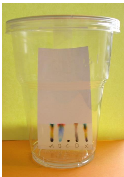
Kuva 1. Rikoksen tekijän viestistä leikataan mustetta sisältävä palanen kromatografiaa varten. Alkuperäisen musteläikän viereen piirretään musteläikät vertailutusseilla.
